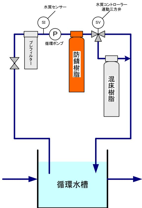
本装置は水槽に貯めた冷却水を特殊防錆樹脂により錆の原因物質塩化イオン( $\text{Cl}^-$ )や硫酸イオン( $\text{SO}_4^{2-}$ )を吸収し、取り込んだ腐食原因物質を防錆イオンに交換することで腐食制御する循環型イオン交換式防錆ユニットです。
